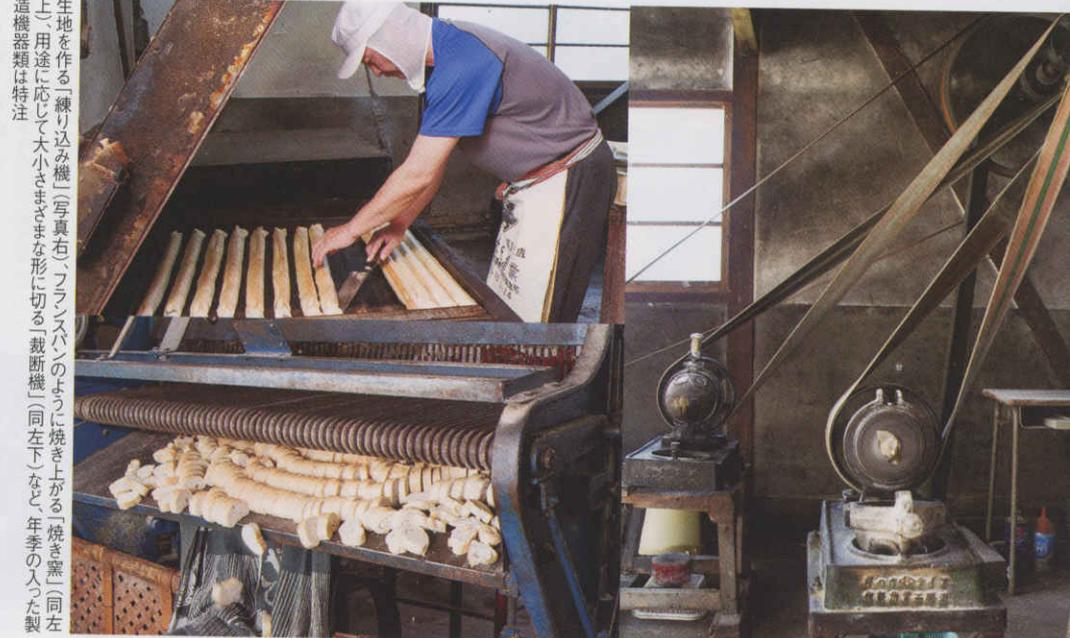
生地を作る「練り込み機」（写真右）、フランスパンのように焼き上げる「焼き窯」（同左上）、用途に応じて小ささまざまな形に切る「裁断機」（同左下）など、年季の入った製造機器類は特注
